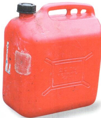
↑ Kuivuttuaan paikka muuttuu lähes läpinäkyväksi. Valmistajan mukaan FiberFix kestää yleisimpiä kemikaaleja, ainakaan bensiini ei pehmentänyt paikkaa.
