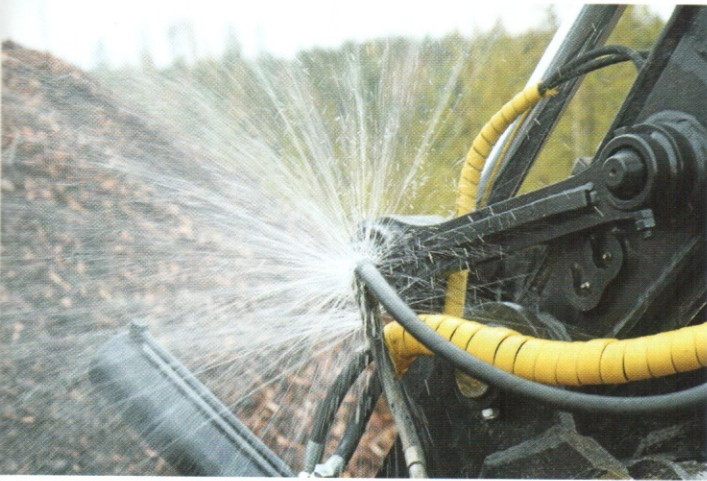
↑ FiberFix kestää painetta 10 barin saakka, joten aivan hydrauliletkuihin se ei sovellu. Onneksi olimme varautuneet tilanteeseen öljyntorjuntavälineistöllä.
