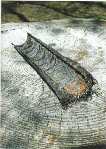
↑ Kovettunut FiberFix muodostaa erittäin kovan massan, jonka irrottaminen vaatii työkaluja. Letkun ympärille kiedottu teippi irrotettiin rälläkällä leikkaamalla.
